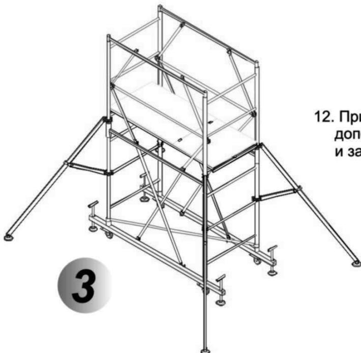
12. При необходимости, для придания вышке-туре дополнительной устойчивости, установить по углам и зафиксировать опоры-стабилизаторы (11)
